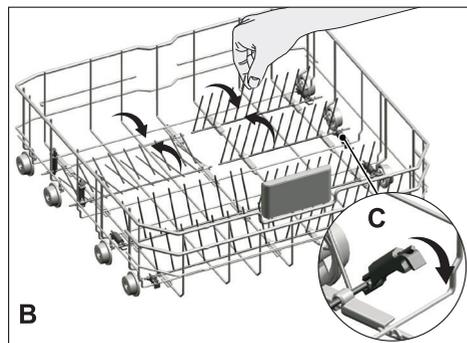
**i** Le fait de mettre les tiges en position horizontale en les tenant par les extrémités peut les amener à se plier. Par conséquent, il serait convenable de disposer les tiges médianes en position horizontale ou verticale en les tenant par leurs manches et en les poussant dans le sens de la flèche.
