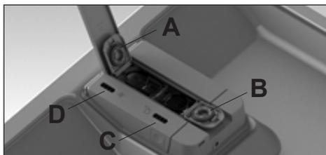
Ouvrez le couvercle indiqué par un (A) sur l'image et ajoutez un produit de rinçage. Ouvrir le couvercle indiqué par un (B), ajoutez du détergent liquide / gel détergent et fermez les couvercles.
