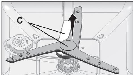
Pour enlever et nettoyer l'ensemble inférieur d'hélice ensemble, tenez les points (C) indiqués sur la figure d'une main et tirez vers le haut pour l'enlever. Après le nettoyage, suivez ces étapes dans l'ordre inverse pour réinstaller l'ensemble de l'hélice.
