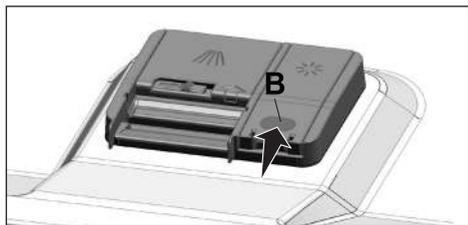
4. S'il y a des taches sur les couverts après le lavage, le niveau doit être augmenté et s'il y a une trace bleue après l'avoir essuyé avec la main, il doit être diminué. Il est réglé sur le niveau 3 comme réglage d'usine.
