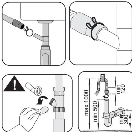
**i** Le tuyau de vidange doit être raccordé aux égouts et ne doit pas être raccordé à une eau de surface.
