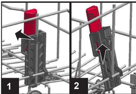
**i** Les supports de lavage de plateaux doivent être retirés comme indiqué dans les figures 1 et 2 pour les tests de contrôle de performance qui doivent être effectués conformément aux normes.
