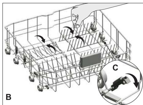
**i** Le fait de mettre les picots en position horizontale en les tenant par les extrémités peut les amener à se plier. Par conséquent, il serait convenable de disposer les picots médians en position horizontale ou verticale en les tenant par leurs manches et en les poussant dans le sens de la flèche..
