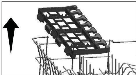
Vous pouvez facilement réinstaller la grille de service multifonction du panier supérieur sur le côté de votre panier supérieur pour l'utiliser à nouveau.
