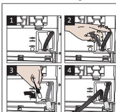
1-2 Tirez à la main le tuyau derrière le sèche-linge afin de le débrancher de son point de connexion. N'utilisez aucun outil pour retirer ce tuyau.
