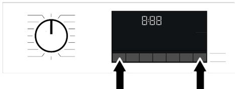
3. Lorsque l'appareil est en mode configuration HomeWhiz, une animation apparaîtra à l'écran et l'icône du Bluetooth cli-gnotera jusqu'à ce que la machine soit appariée avec le périphérique intelligent. Seul le bouton de programme sera actif dans ce mode. Les autres boutons seront inactifs.
