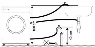
4. Pour éviter que l'eau usée ne rentre à nouveau dans la machine et pour assurer un drainage facile, évitez de plonger l'extrémité du tuyau dans l'eau usée ou de l'insérer dans la conduite d'évacuation à plus de 15 cm. Si le tuyau est trop long, coupez-le.
