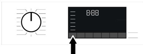
Chaque fois qu'un nouveau programme est sélectionné, la température recommandée pour ledit programme apparaît sur l'indicateur de température. Il est possible que la température recommandée ne soit pas la température maximale pouvant être sélectionnée pour le programme en cours. Appuyez à nouveau sur le bouton de Réglage de la température pour modifier la température. La température décroît graduellement.
