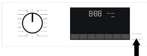
Si le niveau d'eau dans la machine est inapproprié lorsque vous appuyez sur le bouton Départ/Pause, le verrouillage de porte ne peut pas être désactivé et son symbole reste actif à l'écran.
