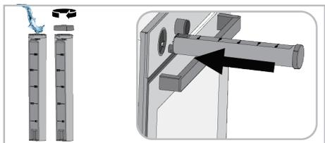
6. Fermez le couvercle et mettez le réservoir d'eau à sa place. Poussez le réservoir d'eau jusqu'au bout.
