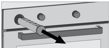
5. Ouvrez le couvercle du réservoir d'eau et remplissez-le avec de l'eau jusqu'au niveau indiqué sur la table de cuisson.
