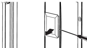
3. Soulevez le couvercle de protection en verre de la lampe à l'aide d'un tournevis. Retirez d'abord la vis, s'il y a une vis sur la lampe carrée de votre produit.
