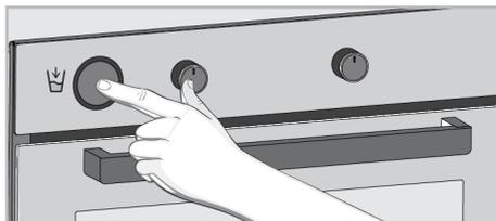
3. Placez le réservoir d'eau dans son emplacement et poussez-le. L'eau commence à remplir la cuve située au fond du four.
