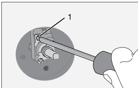
5. Réglez la longueur de flamme sur 2 à 3 mm à l'aide de la vis (1) du robinet du four. Tourner dans le sens des aiguilles d'une montre réduit la flamme, tourner dans le sens inverse des aiguilles d'une montre augmente la flamme.
