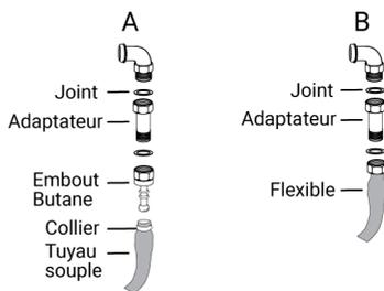
**L'embout butane permet le raccordement par tube souple en caoutchouc de diamètre intérieur de 6 mm destiné aux gaz distribués par bouteilles.**
