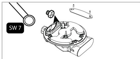
**i** Sur certains brûleurs de table de cuisson, l'injecteur est recouvert d'une pièce métallique. Ce couvercle métallique doit être déposé pour le remplacement de l'injecteur.
