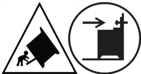
**Avertissement** : Afin d'éviter le basculement de l'appareil, ce moyen de stabilisation doit être installé. Reportez-vous aux instructions d'installation.
