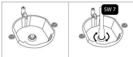
5. Si votre produit est équipé d'une chambre de combustion wok avec un injecteur à entrée latérale, retirez l'injecteur à l'aide d'une clé numéro 7.
