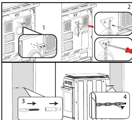
**i** La chaîne de stabilité doit être aussi courte que possible pour éviter que le four ne s'incline vers l'avant et diagonale pour éviter que le four ne s'incline latéralement. La chaîne de stabilité est conçue pour les cuisinières sans fente d'engagement de support.
