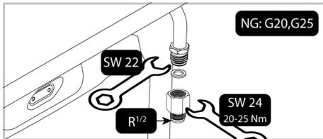
3. Insérer le nouveau joint d'étanchéité dans le flexible/tuyau de gaz de sécurité. S'assurer que le joint est correctement installé.
