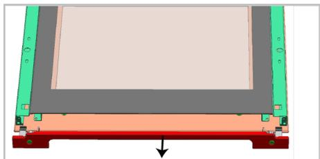
2. Comme illustré sur les figures ci-dessus, appuyez sur les languettes (1) et tirez le profilé (3) vers vous simultanément pour retirer le profilé fixé sur la partie supérieure de la porte avant.
