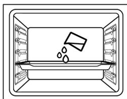
3. Réglez le four sur le mode de fonctionnement "nettoyage vapeur facile" et faites-le fonctionner à 100°C pendant 25 minutes.
