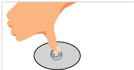
3. Appliquez de l'eau savonneuse préparée au raccord de l'injecteur à l'aide d'une petite brosse. En cas de fuite de gaz au raccord de l'injecteur, l'eau savonneuse commence à mousser. Dans ce cas, serrez l'injecteur avec une force raisonnable et répétez l'étape 3 une fois de plus.
