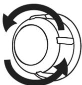
3. Si la lampe du four est de type (A) illustré dans la figure ci-dessous, tournez la lampe du four comme indiqué dans la figure et remplacez-la par une nouvelle.
