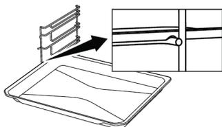
**Mise en place appropriée de la grille métallique et du plateau sur les rails télescopiques - Modèles à étagères grillagées et rails télescopiques**
