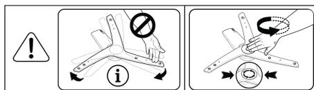
**i** N'essayez pas de faire tourner l'hélice en la tenant par les extrémités. Le fait de tenter de la faire tourner par les extrémités peut entraîner la rupture du système d'engrenages à l'intérieur de l'hélice.
