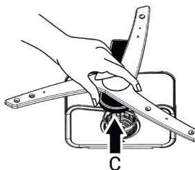
Pour démonter et nettoyer le groupe d'hélices inférieur, saisissez-le d'une main par les points (C) indiqués sur la figure et tirez-le vers le haut. Après le nettoyage, remettez le groupe d'hélices en place en suivant les mêmes étapes dans le sens inverse. (Selon le modèle)
