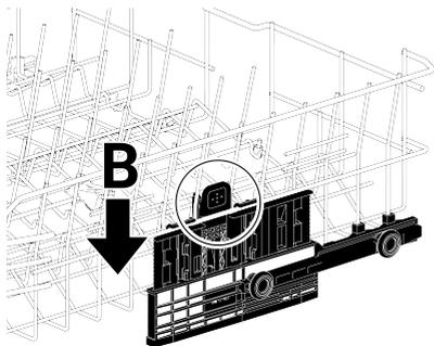
**i** Le mécanisme de mouvement peut ne pas fonctionner correctement lorsque le panier supérieur est surchargé ou lorsque la charge est déséquilibrée. Et il peut aller à la prochaine position inférieure dans des conditions plus lourdes.
