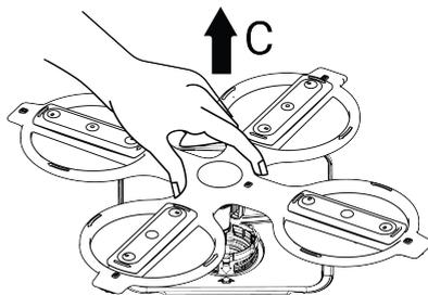
Pour démonter et nettoyer le groupe d'hélices inférieure, saisissez-le d'une main par les points (C) indiqués sur la figure et tirez-le vers le haut. Après le nettoyage, remettez le groupe d'hélices en place en suivant les mêmes étapes dans le sens inverse. (Selon le modèle)
