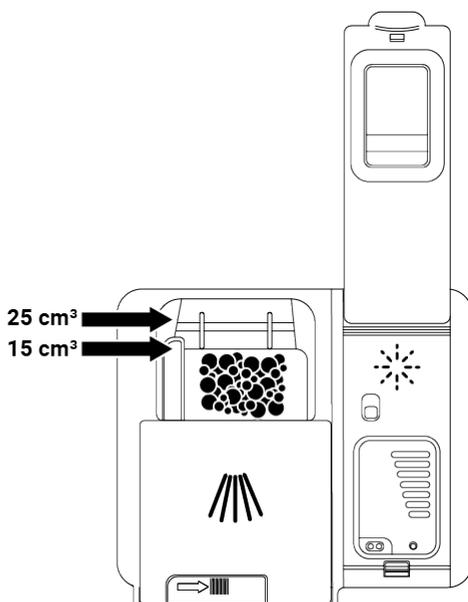
3. Fermez le couvercle du compartiment à détergent en le poussant dans le sens de la flèche. Un « clic » se fait entendre lorsque le couvercle est fermé.
