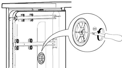
Le réglage de l'entretien de la verrerie permet de modifier la dureté de l'eau de lavage pré-adouci dans le lave-vaisselle. Effectuez le réglage en fonction de la dureté de l'eau. Effectuez le réglage à l'aide d'un tour-
