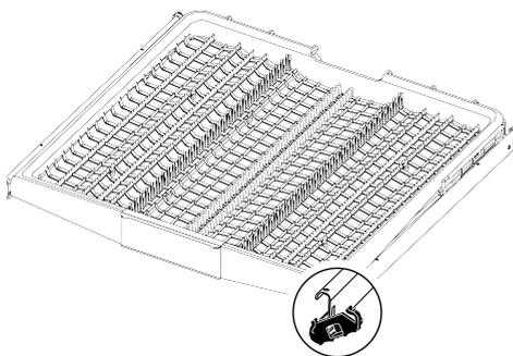
Dans les modèles à mouvement partiel, lorsque le bras (1) de la poignée est poussé, le plateau de la partie centrale du panier descend en position basse ; le système est déverrouillé et les plateaux latéraux droit et gauche peuvent être déplacés librement. Le déplacement des plateaux latéraux libère de l'espace et permet de charger les plats longs dans le panier supérieur.
