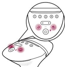
1 برای روشن کردن دستگاه دکمه روشن/خاموش را فشار دهید. این دستگاه با تنظیم شدت نور 1 شروع به کار می کند.
