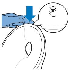
Se acordar durante a noite, pode tocar na parte superior do aparelho para ativar uma luz ténue. Esta luz cor de laranja ténue e discreta fornece-lhe apenas a luz suficiente para se orientar no escuro. Desligue a luz noturna ao tocar novamente na parte superior do aparelho.
