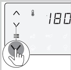
6 Utilisez le bouton de diminution/augmentation de la température pour sélectionner la température requise.
