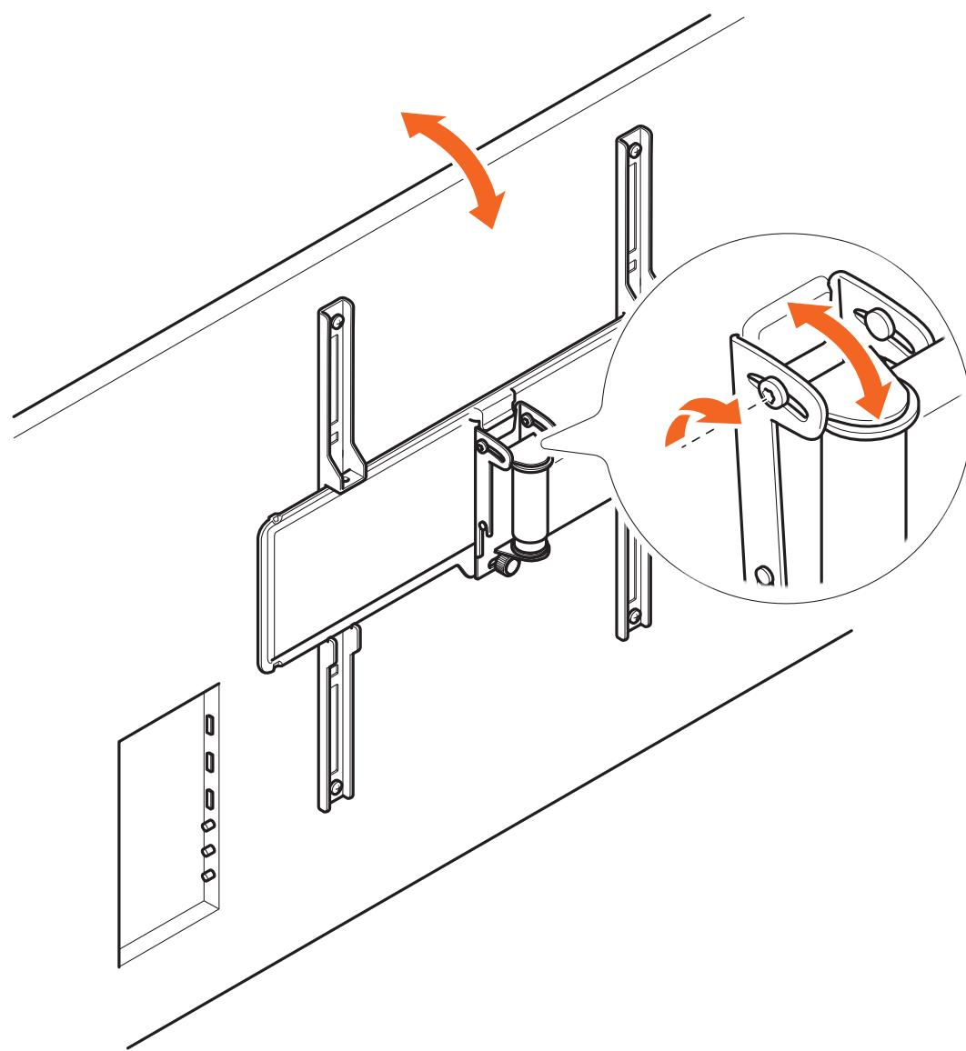
1. Desserrez les deux boulons des deux côtés avec une clé Allen de 4 mm ; ne les retirez pas complètement.
