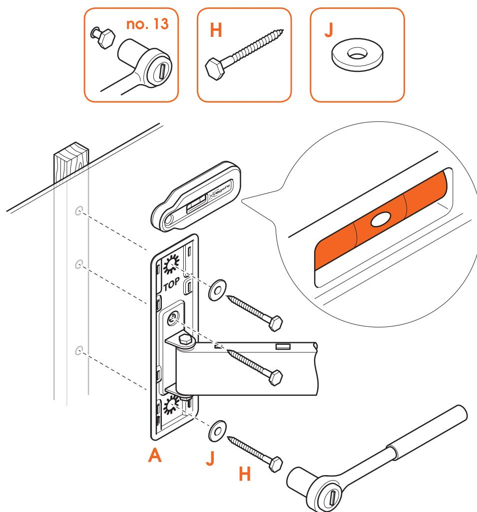
5. Fixez le support mural **A** aux montants en bois à l'aide des vis **H** et des rondelles **J**. Utilisez le niveau à bulle pour niveler le support mural.
