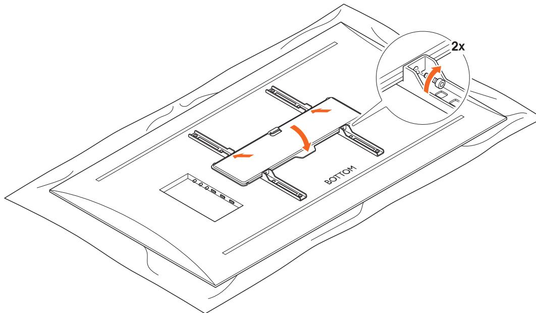
4. Placez la barre d'interface ® dans l'espacement prévu des bandes d'interface ©. Assurez-vous que la barre d'interface ® est placée dans une position centrée.
