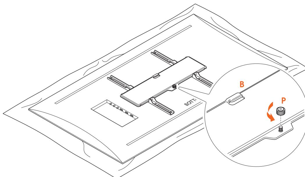
6. Retirez l'écrou à ailettes ® de la barre d'interface ®.
