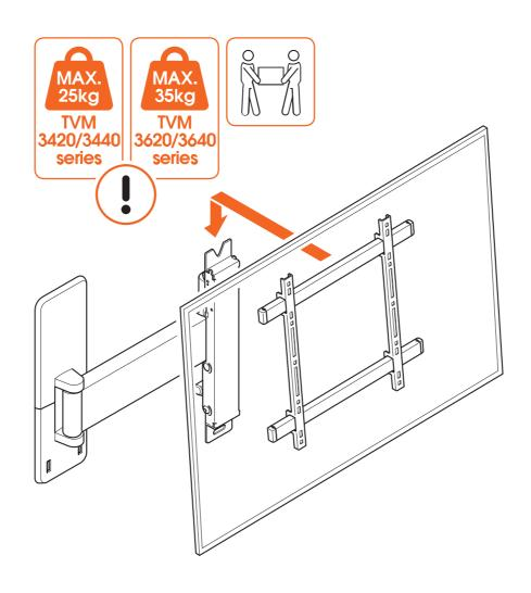
1. Soulevez avec précaution et fixez le téléviseur au **support mural** (a). Placez l'**écrou à ailettes** supérieur (b) dans l'encoche supérieure du support mural.
