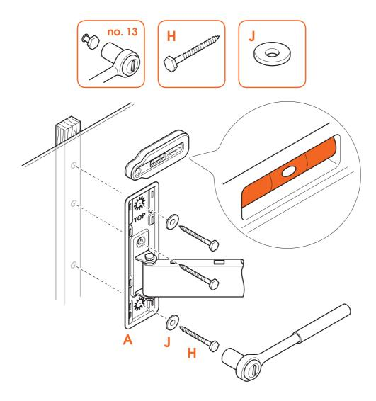
4. Fixez le **support mural** ⓐ au mur en bois à l'aide des **vis** ⊕ et des **rondelles** ⓓ. Utilisez le **niveau à bulle** ⊚ pour niveler le support mural.
