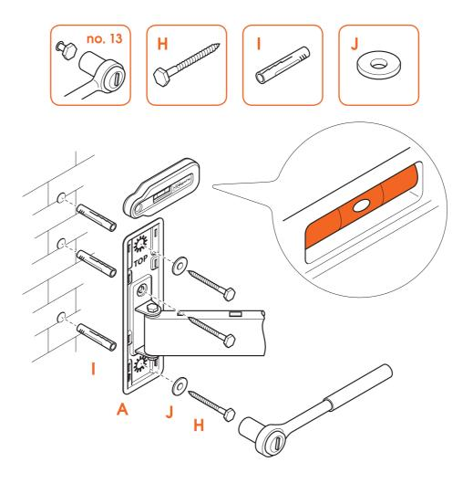
3. Fixez le **support mural** (a) au mur avec les **vis** (b), les **rondelles** (c) et les **chevilles** (c). Utilisez le **niveau à bulle** (c) pour niveler le support mural.
