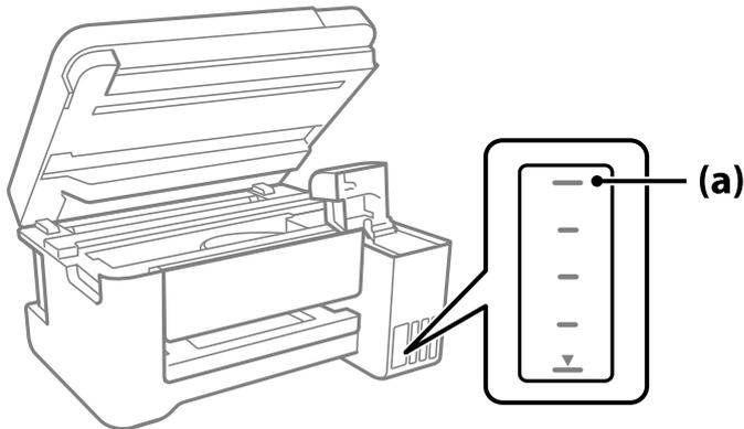
10. Alignez le sommet du flacon avec la goulotte de remplissage, puis insérez-le dans celle-ci pour remplir l'encre jusqu'à ce qu'elle atteigne la ligne supérieure et que l'écoulement s'arrête automatiquement.
