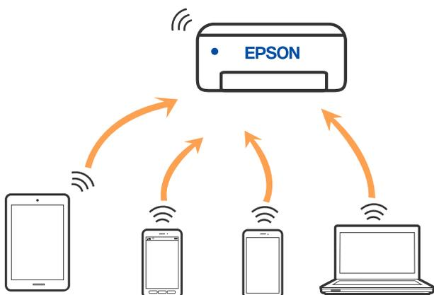
L'imprimante peut être connectée simultanément via Wi-Fi et Wi-Fi Direct (PA unique). Cependant, si vous initiez une connexion réseau en mode Wi-Fi Direct (PA unique) lorsque l'imprimante est connectée en Wi-Fi, le Wi-Fi est temporairement déconnecté.
