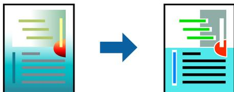
L'option **PhotoEnhance** permet d'obtenir des images plus nettes et des couleurs plus vives grâce au réglage automatique du contraste, de la saturation et de la luminosité des données de l'image d'origine.
