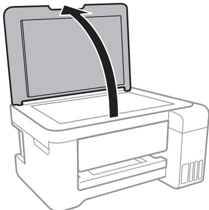
2. Nettoyez la surface de la vitre du scanner à l'aide d'un chiffon doux, sec et propre.
