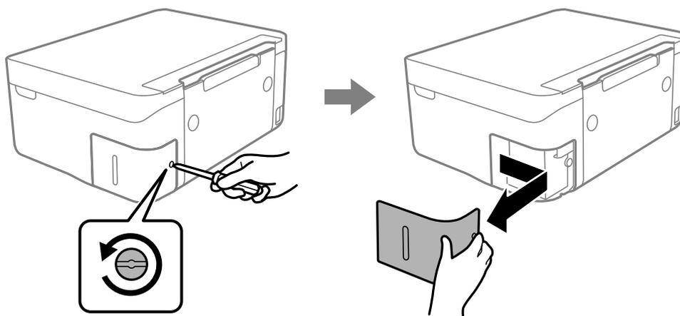
3. Retirez le boîtier de maintenance utilisé.
