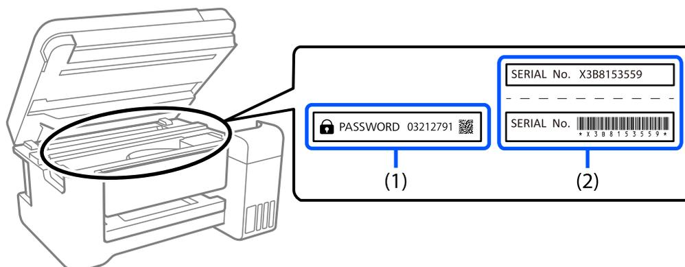
Si deux étiquettes (1) et (2) sont attachées, la valeur à côté de PASSWORD sur l'étiquette de (1) est le mot de passe par défaut. Dans cet exemple, le mot de passe par défaut est 03212791.
