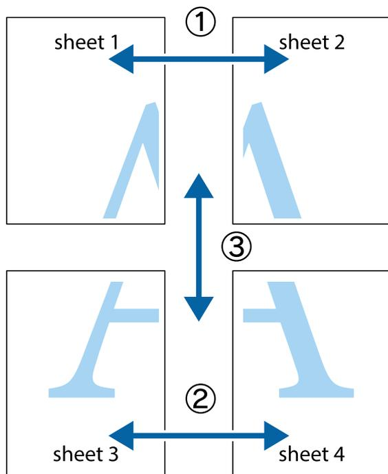
1. Préparez Sheet 1 et Sheet 2. Coupez les marges de Sheet 1 le long de la ligne bleue verticale en passant par le centre des croix inférieure et supérieure.
