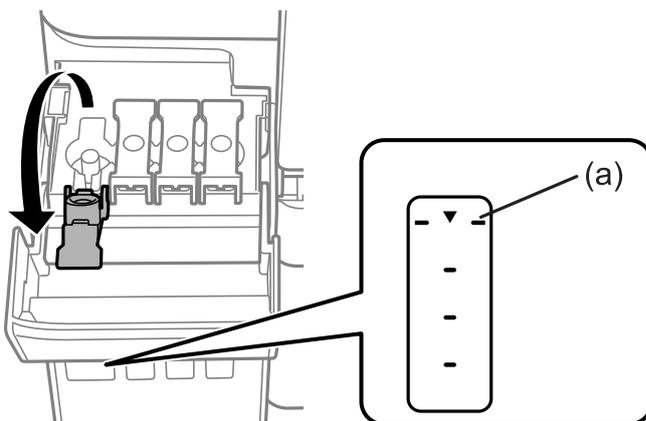
8. Alignez le sommet du flacon avec la goulotte de remplissage, puis insérez-le dans celle-ci pour remplir l'encre jusqu'à ce qu'elle atteigne la ligne supérieure et que l'écoulement s'arrête automatiquement.
