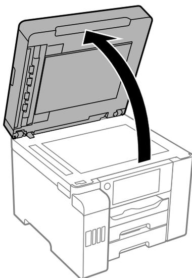
2. Nettoyez la surface de la vitre du scanner à l'aide d'un chiffon doux, sec et propre.
