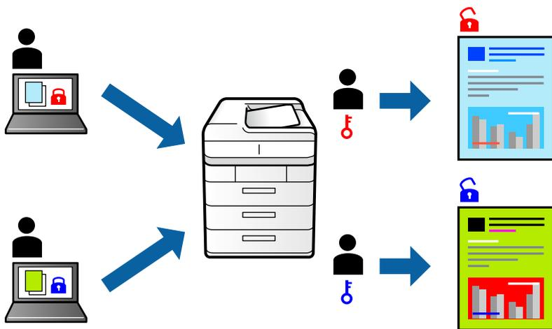
1. Dans l'onglet **Plus d'options** du pilote d'impression, sélectionnez **Job confidentiel** et saisissez un mot de passe.
