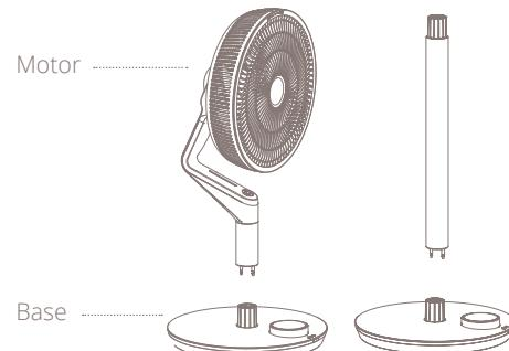
**Hinweis:** Der größte der beiden Stifte muss mit dem größten der beiden Löcher übereinstimmen. Die Stifte sind nicht gleich groß, um eine ordnungsgemäße Verbindung in nur einer Ausrichtung zu gewährleisten.
