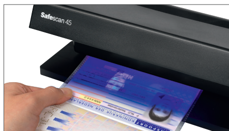
Vérifie les caractéristiques UV des passeports et autres pièces d'identité
