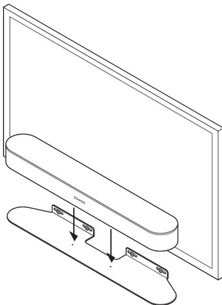
8. Insérez les vis de fixation et serrez-les pour fixer la Beam au support.
