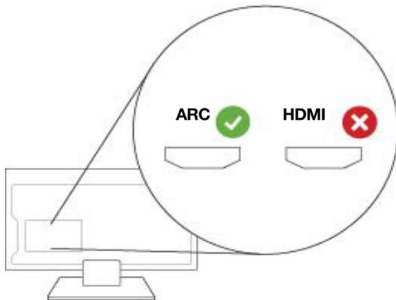
2. Connectez le câble HDMI au port **HDMI ARC** de la TV.
