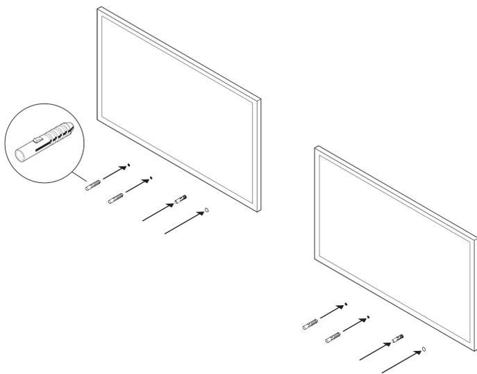
5. Placez le support sur le mur et serrez légèrement les vis murales pour le fixer. Vérifiez avec un niveau à bulles, puis finissez de serrer les vis.
