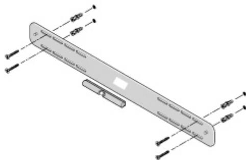
6. Placez le support sur le mur et serrez légèrement les vis pour le fixer. Vérifiez avec un niveau à bulles, puis finissez de serrer les vis.
