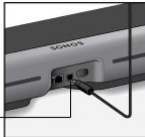
**IMPORTANT :** Retirez les capuchons de protection pour chaque extrémité du câble audio optique fourni avant l'insertion.
