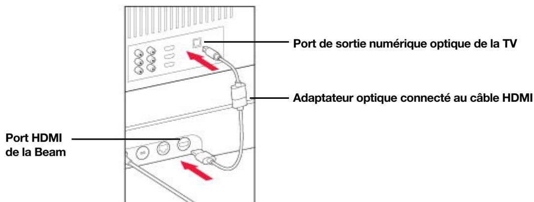
**Remarque :** Le port de l'adaptateur optique est en forme de « D ». Assurez-vous par conséquent d'aligner correctement le connecteur dans le port. Une insertion incorrecte de l'adaptateur risque d'endommager le câble.
