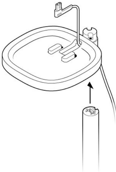
4. Utilisez les 2 vis argentées pour fixer le socle de l'enceinte en haut du montant, en faisant passer le câble d'alimentation avec précaution. Enclenchez la partie inférieure du socle en orientant le canal du câble d'alimentation vers l'arrière, puis montez le socle sur le montant.
