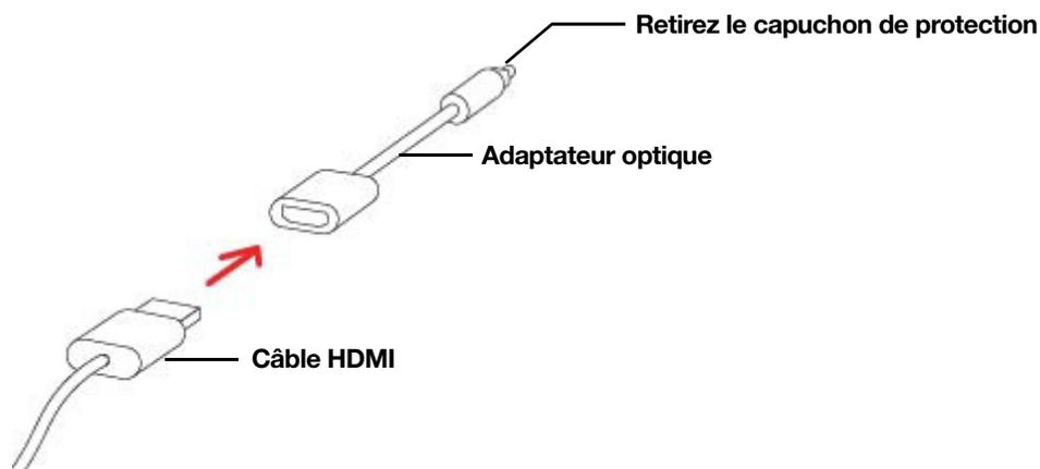
3. Branchez l'adaptateur optique au port **de sortie (OUT) numérique optique** de la TV.
