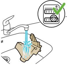
6 Sciacquate il beccuccio di erogazione del caffè sotto l'acqua corrente calda. Potete anche pulirlo in lavastoviglie.
