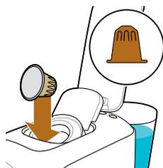
5 Setzen Sie eine Kapsel ein.
