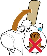
3 Setzen Sie keine neue Kapsel ein und schließen Sie den Hebel.
