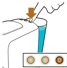
7 Druk op de knop voor de gewenste koffiesoort. De knop gaat branden en het apparaat wordt opgewarmd. Wanneer de opwarming is voltooid, begint het apparaat met koffiezetten.
