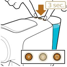
7 Die Kaffeemaschine gibt die gesamte Entkalkungslösung in regelmäßigen Intervallen aus. Dies dauert bis zu 30 Minuten.
