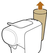
**2** Enxague e encha o depósito de água debaixo da torneira. Volte a introduzir o depósito de água na máquina.
