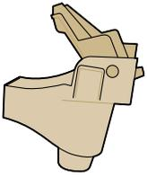
5 Open de kap om de koffie-uitloop grondig te reinigen.
