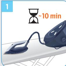
**DA** Figur 3: Det slukker automatisk, når det ikke har været brugt i 10 minutter.
