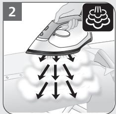
**DE** Abbildung 1: Drücken Sie zweimal schnell auf den Dampfauslöser, um den Dampfstoß auszulösen.
