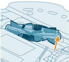
5 Gunakan alat pembersih untuk memotong rambut.
