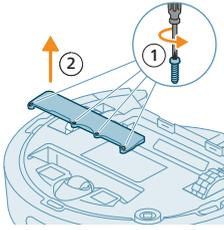
3 Desenrosque los tornillos del compartimento de la batería y quite la tapa.
