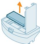
7 Промойте моющийся фильтр водой и высушите его на воздухе.
