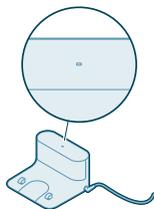
Indikatorlyset på stationen er slukket. Stationen er ikke sat i stikkontakten.
