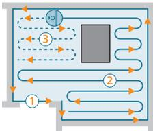
Робот прибирає приміщення в структурованому порядку. Він очищає кімнату за кімнатою, завжди починаючи з їхнього периметру й закінчуючи рештою поверхонь.
