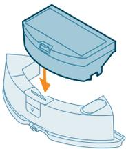
9 Setzen Sie den Staubbehälter wieder auf den Wasserbehälter.
