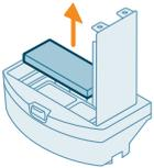
7 Bilas filter yang dapat dicuci dengan air dan kering anginkan di udara terbuka.
