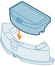
10 Insérez le réservoir d'eau dans le robot.
