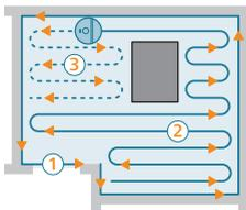
Robotti siivoaa kodin järjestelmällisesti. Robotti siivoaa huoneen kerrallaan ja aloittaa aina siivoamalla huoneen reunat, ennen kuin se siirtyy huoneen muihin osiin.
