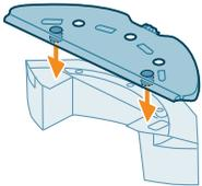
**2** Σύρετε την ίσια πλευρά του πέλματος σφουγγαρίσματος στη σωστή εγκοπή της υποδοχής του πέλματος σφουγγαρίσματος και συνδέστε το πλενόμενο πέλημα σφουγγαρίσματος στο υλικό velcro της υποδοχής του πέλματος σφουγγαρίσματος.
