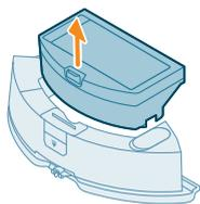
3 Retira el depósito de polvo del depósito de agua.
