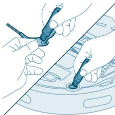
3 Χρησιμοποιήστε μια βούρτσα με μαλακές τρίχες (π.χ. οδοντόβουρτσα) για να αφαιρέσετε τη σκόνη ή το χνούδι από την πλαινή βούρτσα και το ρομπότ.
