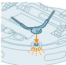
4 Zamocuj szczotkę boczną, wciskając ją w prawidłowym położeniu na dole robota.
