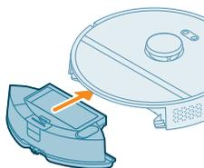
**10** Vložte nádobu na vodu do robota.
