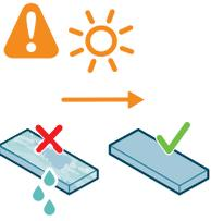
7 Промийте фільтр водою та дайте йому висохнути на повітрі.
