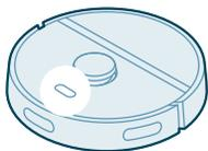
Kontrolka indikátoru na robotu se rozsvítí bíle.
