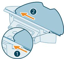
**⚠ VIKTIGT:** Moppmunstycket kan tas bort. När du använder roboten med moppmunstycket ska dock den tvättbara moppdynan alltid fästas på moppmunstycket, även om du använder roboten utan mopning. Detta för att förhindra skador på golvet och moppållaren vid användning.
