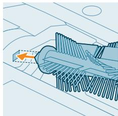
8 Instalați peria principală în locația corectă. Potrivii piciorușul pătrat cu orificiul pătrat și introduceți peria în poziție.
