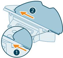
⚠️ تعليمات هامة: يمكن إزالة حامل بطانة الممسحة، ولكن عند استخدام الروبوت مع حامل بطانة الممسحة، يجب دائمًا توصيل بطانة الممسحة القابلة للغسل بحامل بطانة الممسحة، حتى إذا كنت تستخدم الروبوت بدون مسح. هنا لمنع تلف الأرضية وحامل الممسحة أثناء الاستخدام.
