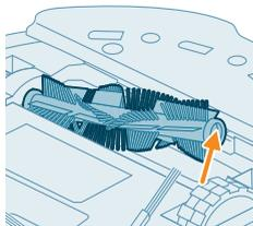
**5** Pomocí nástroje na čištění přestříhejte vlasy.
