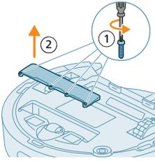
4 باتری قابل شارژ را بردارید و با فشار دادن گیره کوچک روی متصل کننده باتری آن را جدا کنید تا متصل کننده باتری آزاد شود.
