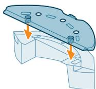
2 将可水洗拖布的直边正确滑入拖布支架的槽位中，并将可水洗拖布粘到支架的魔术贴材料上。
