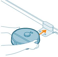
3 قم بدفع الروبوت مقابل المحطة بحيث تتلامس جهات اتصال الشحن الخاصة بالروبوت مع جهات اتصال الشحن الخاصة بالمحطة.
