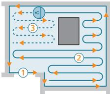
Робот-пылесос убирает дом структурированным образом. Робот-пылесос убирает комнату за комнатой и всегда начинает с уборки краев комнаты, прежде чем перейти к остальной поверхности.
