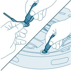
3 Gebruik een borstel met zachte borstelharen (zoals een tandenborstel) om stof of pluïesjes van de zijborstel en de robot te verwijderen.
