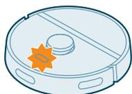
Indikatorlampen på roboten blinker i oransje.
