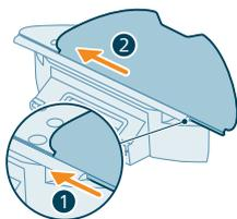
**⚠ IMPORTANTE:** É possível remover o suporte para a base da esfregona. No entanto, quando utilizar o robot com o suporte para a base da esfregona, a base de esfregona lavável deve estar sempre fixada no suporte para a base da esfregona, mesmo que utilize o robot sem lavar o chão. Deste modo, evita possíveis danos no chão e no suporte para a esfregona durante a utilização.
