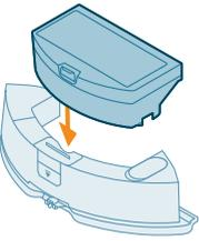
10 Introduceți rezervorul de apă în robot.
