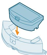
**10** Sätt in vattenbehållaren i roboten.
