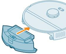
10 Inserte el depósito de agua en el robot.
