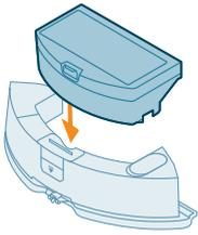
9 Vuelve a insertar el depósito de polvo en el depósito de agua.
