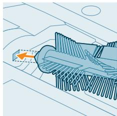
8 将主刷安装在正确位置。将方形桩与方形孔对齐，并将刷插入到位。
