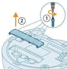
3 Ta bort skruvarna på batterifacket lock och ta bort locket.
