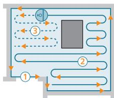
Robotten rengør hjemmet på en struktureret måde. Robotten rengør rum for rum og starter altid med at rengøre rummets periferi, inden den dækker den resterende overflade.
