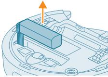
4 Extraiga la batería recargable y desconéctela presionando el pequeño clip del conector de la batería para soltar el conector de la batería.
