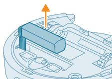
4 Estraiete la batteria ricaricabile e scollegatela premendo il fermo sul relativo connettore per sganciare il connettore.
