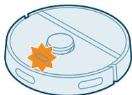
Svjetlosni indikator na robotu treperi u narančastoj boji.
