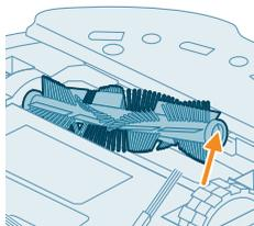
5 از ابزار تمیز کننده برای بریدن موها استفاده کنید.
