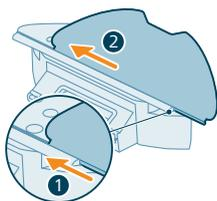
**⚠ ΣΗΜΑΝΤΙΚΟ:** Η υποδοχή του πέλματος σφουγγαρίσματος μπορεί να αφαιρεθεί. Αλλά όταν χρησιμοποιείτε το ρομπότ με την υποδοχή του πέλματος σφουγγαρίσματος, πρέπει πάντα το πλενόμενο πέλμα σφουγγαρίσματος να είναι προσαρτημένο στην υποδοχή του, ακόμα και όταν χρησιμοποιείτε το ρομπότ χωρίς να σφουγγαρίζετε. Αυτό είναι για να αποτρέψετε ζημιά στο δάπεδο και στην υποδοχή του πέλματος κατά τη χρήση.
