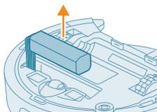
4 Løft det genopladelige batteri ud, og afmonter det ved at trykke på den lille klemme på batteristykket for at frigøre batteristykket.
