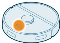
Svjetlosni indikator na robotu treperi u bijeloj i narančastoj boji.
