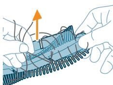
**Wskazówka:** Użyj końca narzędzia do czyszczenia szczotek, aby usunąć zanieczyszczenia ze szczotki głównej.
