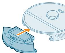
10 Posizionate il serbatoio dell'acqua nel robot.
