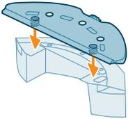
2 Geser sisi lurus dari kain pel yang dapat dicuci ke dalam slot yang benar pada penahan kain pel dan pasang kain pel yang dapat dicuci ke kain velcro pada penahan kain pel.
