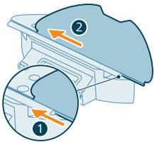
**2** Trượt mặt phẳng của tấm lau có thể giặt được vào đúng khe của giá đỡ tấm lau và gắn tấm lau có thể giặt được vào vật liệu dán khóa của giá đỡ tấm lau.
