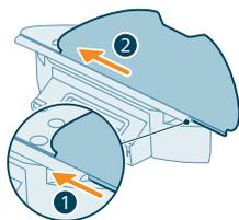
**⚠ POMEMBNO:** Držalo krpe za brisanje lahko odstranite. Ko pa uporabljate robota z držalom krpe za brisanje, mora biti pralna krpa za mokro brisanje vedno pritrjena na držalo krpe za brisanje, tudi če uporabljate robota brez mokrega brisanja. Tako boste med uporabo preprečili poškodbe tal in držala krpe za brisanje.
