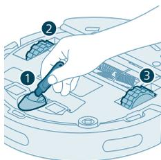
**i** Na odstránenie prachu a nečistôt z koliesok môžete použiť kefový koniec čistiaceho nástroja.
