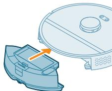
10 将水箱插入扫拖机器人。
