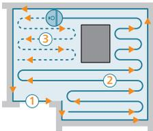
Der Roboter reinigt Ihr Zuhause auf strukturierte Weise. Der Roboter reinigt Raum für Raum und beginnt immer zuerst mit der Reinigung der Ecken, bevor er den Rest der Fläche abdeckt.
