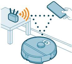
**3** Натиснете и задръжте едновременно бутона за старт/стоп и бутона home в продължение на три секунди. Светлинните индикатори в бутоните ще мигат в оранжево, за да покажат, че роботът е в режим на настройка на Wi-Fi.
