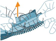
**☛ Συμβουλή:** Χρησιμοποιήστε το άκρο του εργαλείου καθαρισμού, για να αφαιρέσετε τη βρωμιά στην κύρια βούρτσα.
