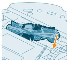
8 Helyezze be a fő kefét a megfelelő helyre. Illessze a négyzet alakú csapot a négyzet alakú nyíláshoz, és helyezze a kefét a helyére.
