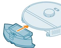
10 Setzen Sie den Wasserbehälter in den Roboter ein.
