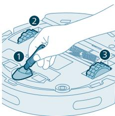
1 Połóż robota spodem do góry na płaskiej i stabilnej powierzchni.
