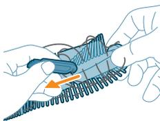
**6** Vlasy a nečistoty z hlavního kartáče odstraňte.
