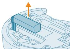
4 Lyft ur det laddningsbara batteriet och koppla från det genom att trycka på den lilla klämman på batterikontaktdonet för att lossa batteriet från kontaktdonet.
