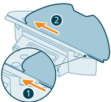
**⚠ ข้อสำคัญ:** ที่ตัดแผ่นดูพื้นสามารถถอดออกได้ แต่เมื่อขณะใช้งานหุ่นยนต์ที่มีที่ตัดแผ่นดูพื้น จะต้องตัดแผ่นดูพื้นแบบทำความสะอาดได้ไว้กับที่ตัดแผ่นดูพื้นเสมอ แม้ว่า你会ใช้หุ่นยนต์โดยไม่ได้ดูพื้นก็ตาม ซึ่งทำเพื่อป้องกันความเสียหายที่จะเกิดกับพื้นและที่ตัดแผ่นดูพื้นขณะใช้งาน
