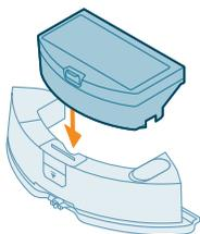
10 Вставьте резервуар для воды в робот-пылесос.
