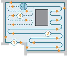
Robotas valo namus pagal tam tikrą struktūrą. Robotas valo patalpą po patalpos ir visada pirmiausia pradeda valyti patalpos kraštus, o tik tada – likusį paviršių.
