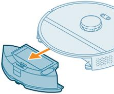
3 Вийміть пілозбірник із резервуара для води.
