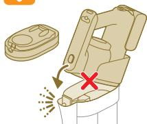
**⚠️ Opozorilo:** Ročne enote 3 v 1 ne nameščajte na komoro za prah, če ni ohišje filtra vstavljeno v komoro za prah.
