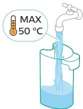
**9** Zásobník na čistú vodu napľňte aspoň po značku AUTOCLAN studenou alebo vlažnou vodou z vodovodu.
