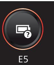
E5   | Batteriet er kun halvt sat i.                      | Sørg for, at batteriet er sat korrekt i (se "Samling af støvsugnings- og moppesystemet").                                                                                                                                                                                                                    |
