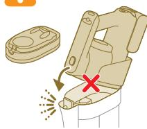
**⚠ 警告:** 当集尘桶中没有插入滤网盒时, 请勿将手持设备安装到集尘桶。
