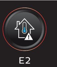
E2   | Temperaturen er for lav.                           | Sørg for, at temperaturen i det rum, hvor apparatet bruges, opbevares eller oplades, er over 5 °C.                                                                                                                                                                                                           |
