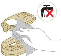
**⚠ Let op:** Reinig het witte materiaal van het deksel van de filterbehuizing niet met een normale stofzuiger of een borstel. Maak het witte materiaal van het deksel van de filterbehuizing niet schoon met water of een reinigingsmiddel. Het zal het materiaal beschadigen. Het witte materiaal kan boven een bak worden uitgeklopt.
