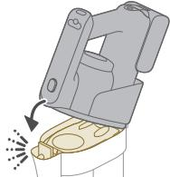
**⚠ Figyelem!** Ne csatlakoztassa a 3 az 1-ben kézi egységet a portartályhoz, amíg nem helyezte be a szűrőházat a tartályba.
