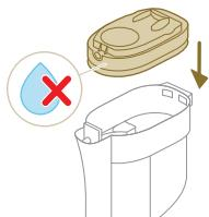
**⚠ Varoitus:** Varmista, että vaahtomuovisuodattimen sisältävä suodatinkoteloon on täysin kuiva, ennen kuin asetat sen takaisin pölysäiliöön.
