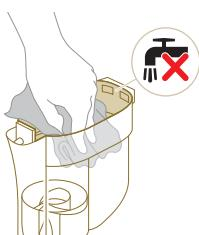
5 Aseta suodatinkotelon kansi takaisin paikalleen, kun pölysäiliö on kuiva.
