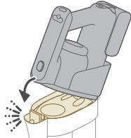
**⚠ Varoitus:** Älä kiinnitä 3-in-1-rikkaimuria pölysäiliöön, jos suodatinkoteloa ei ole asetettu pölysäiliöön.
