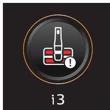
AquaSpin 吸頭卡住。如果有異物卡在吸頭中 (例如電源線或玩具)，這可做為安全停止運作的機制。
