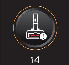
i4 | Die LED-Düse klemmt. Dies ist eine Sicherheitsabschaltung für den Fall, dass etwas in der Düse stecken bleibt (z. B. ein Stromkabel oder ein Spielzeug).             | Überprüfen Sie die Bürstenrolle und den Rest der Düse auf Haare oder andere Fremdkörper, und entfernen Sie diese (siehe 'Die Bürstenrolle reinigen'). Wenn keine Fremdkörper vorliegen, kann ein Aus- und Einschalten des Geräts das Problem lösen. |
