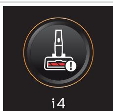
LED吸嘴卡住。这是一个安全保护装置，如果有异物（例如，电缆或玩具）卡在吸嘴中，会切断电源。
