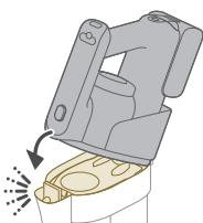
**1** 要组装仅吸尘装置，请将手持设备安装到集尘桶上（可听到“咔哒”一声）。
