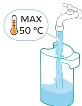
**9** Napunite rezervoar za čistu vodu hladnom ili mlakom vodom iz slavine barem do oznake AUTOCLEAN.
