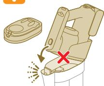
**! Forsiktig:** Ikke koble til 3-i-1 håndstøvsuger til støvbeholderen uten at filterhylsen er satt inn i støvbeholderen.
