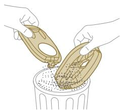
**5** Scuotete l'elemento filtrante e il coperchio sul bidone della spazzatura per rimuovere la polvere.
