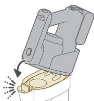
**5** Ponovo spojite dršku 3-u-1 na posudu za prašinu. Proverite da li ste prvo spojili zadnji deo, a zatim spojite prednji deo tako da nalegne na mesto uz zvuk klik-a.
