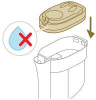
**⚠ Let op:** Zorg ervoor dat de filterbehuizing met het schuimfilter volledig droog is voordat u ze terugplaatst in de stofemmer.
