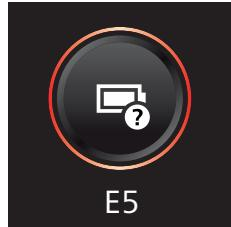
E5 | La batería está a medio insertar. | Asegúrate de que la batería esté insertada correctamente (ver "Montaje del conjunto de aspiración y mopa").
