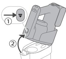
**1** Drücken Sie die Entriegelungstaste (1), um das 3-in-1-Handstück vom Staubbehälter zu lösen, und heben Sie dann das 3-in-1-Handstück vom Gerät (2) ab.
