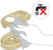
**⚠️ Varning!** Rengör inte det vita materialet på filterlådans lock med en vanlig dammsugare eller borste. Rengör inte det vita materialet på filterlådans lock med vatten eller rengöringsmedel. Detta skadar materialet. Det vita materialet kan knackas över en soptunna.
