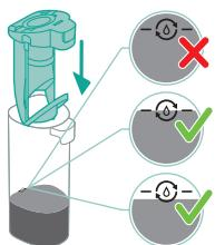
**i** Obs! Om smutsvattennivån är under AUTOCLEAN-nivån är det inte nödvändigt att tömma tanken innan du startar AUTOCLEAN-programmet. Du kan hoppa över följande steg och gå direkt till steg 6.
