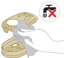
**⚠ Precaución:** no limpie el material blanco de la tapa de la carcasa del filtro con un aspirador normal ni con un cepillo. No limpie el material blanco de la tapa de la carcasa del filtro con agua ni con ningún producto de limpieza. Ello dañaría el material. Pueden darse golpecitos al material blanco por encima del cubo de la basura.
