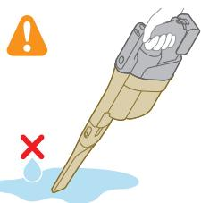
**⚠️ คำเตือน: ห้ามดูดน้ำหรือของเหลวอี่นๆ**
