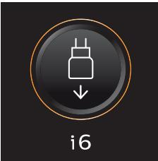
i6    | Tīkla filtrs netīrā ūdens tvertnē ir bloķēts. | Iztīriet tīkla filtru, izmantojot komplektācijā iekļauto tīrišanas birstīti.                                                                                                                                                                                                                                                                                                                                           |
