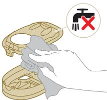
**⚠️ Opozorilo:** Belega materiala na pokrovu ohišja filtra ne čistite z običajnim sesalnikom ali krtačo. Belega materiala na pokrovu ohišja filtra ne čistite z vodo ali čistilnim sredstvom. S tem boste poškodovali material. **Beli material potapkajte nad smetnjakom.**
