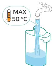
**9** Remplissez le réservoir d'eau propre avec de l'eau du robinet, froide ou tiède, au moins jusqu'à l'indication AUTOCLEAN.
