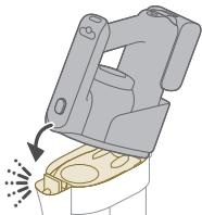
**⚠ Attenzione:** non collegate l'apparecchio portatile 3-in-1 al recipiente della polvere senza aver prima inserito l'elemento filtrante nel recipiente della polvere.
