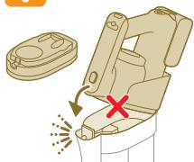
**⚠ Attenzione: non ricollegate l'apparecchio portatile 3-in-1 al recipiente della polvere senza aver prima inserito l'elemento filtrante nel recipiente della polvere.**
