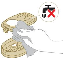
**⚠️ Výstraha:** Biely materiál veka puzdra filtračného valca nečistite bežným vysávačom ani kefkou. Biely materiál veka puzdra filtračného valca nečistite vodou ani čistiacimi prostriedkami. Dôjde k jeho poškodeniu. Biely materiál možno vyčistiť vyklepaním nad košom.
