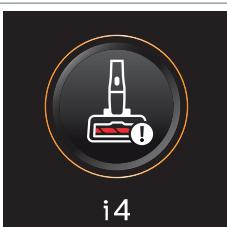
LED hubica sa zasekla. Ide o bezpečnostnú pojistku pre prípad, že sa v hubici niečo zasekne (napríklad napájajúc kábel alebo hračka).
