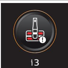
Hubica AquaSpin sa zasekla. Ide o bezpečnostnú pojistku pre prípad, že sa v hubici niečo zasekne (napríklad napájajúc kábel alebo hračka).
