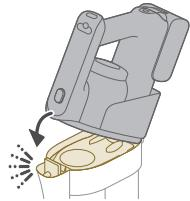
**⚠ Przestroga: Nie mocuj odkurzacza ręcznego 3 w 1 do pojemnika na kurz, gdy do pojemnika nie jest włożona obudowa filtru.**
