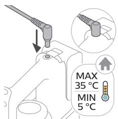
**11** Oplad apparatet. Sæt strømstikket ind i stikket på apparatets bagside. Tilslut derefter adapteren til stikkontakten.
