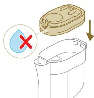
**⚠ Výstraha:** Pred vložením späť do nádoby na prach sa uistite, že je puzdro filtračného valca vrátane penového filtra úplne suché.
