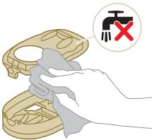
**⚠ Forsigtig:** Rengør ikke filterkabinetts hvide materiale med en almindelig støvsugeren eller en børste. Rengør ikke filterkabinetts hvide materiale med vand eller rengøringsmiddel. Dette vil beskadige materialet.
