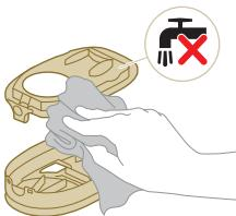
**⚠️ Oprez:** nemojte čistiti bijeli materijal poklopca kućišta filtra uobičajenim usisavačem ili četkom. Nemojte čistiti bijeli materijal poklopca kućišta filtra vodom ili nekim sredstvom za čišćenje. To će oštetiti materijal. Bijeli materijal može se otresti iznad kante za otpad.
