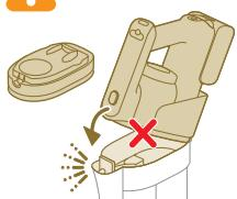
**! Forsigtig:** Tilslut ikke det håndholdte 3-i-1-system til støvbeholderen igen, uden at filterkabinetet er isat i støvbeholderen.
