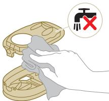
**⚠️ Oprez:** Nemojte čistiti beli materijal poklopca kućišta filtera običnim usisivačem ili četkom. Nemojte čistiti beli materijal poklopca kućišta filtera vodom ili nekim sredstvom za čišćenje. To će oštetiti materijal. Beli materijal možete da otresate u kanti za otpatke.
