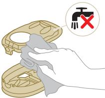
**⚠️ Upozornění:** Bílý materiál víka pouzdra filtračního válce nečistěte běžným vysavačem ani kartáčkem. Bílý materiál víka pouzdra filtračního válce nečistěte vodou ani čisticími prostředky. Došlo by k jeho poškození.
