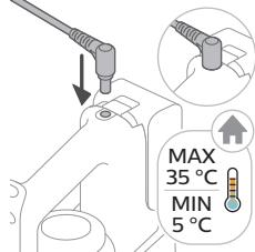
**11** Laden Sie das Gerät auf. Stecken Sie den Gerätestecker in die Buchse auf der Rückseite des Geräts. Stecken Sie dann den Adapter in die Steckdose.
