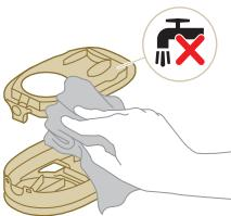
**⚠ Atsargiai!** Nevalykite baltos filtro dėklo dangtelio medžiagos įprastu dulkių siurbliu arba šepečiu. Neplaukite baltos filtro dėklo dangtelio medžiagos vandeniu ar bet kokia valymo medžiaga. Taip medžiaga bus pažeista. Baltą medžiagą galima išpurtyni virš šiukšlių dėžės.
