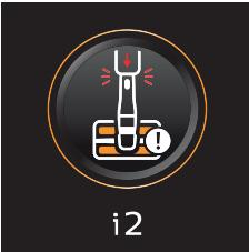
i2  | Die AquaSpin-Düse ist nicht (korrekt) befestigt.                                                                                                                     | Befestigen Sie die AquaSpin-Düse.                                                                                                                                                                                                                   |
