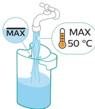
**6** 將冷自來水或溫自來水注入淨水箱至 MAX 刻度。
