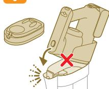
**⚠ Precaución: no vuelva a conectar el aspirador de mano 3 en 1 a la cubeta para el polvo sin que la carcasa del filtro esté insertada en la cubeta para el polvo.**
