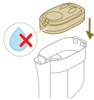
**⚠ Forsiktig:** Kontroller at filterhyslen, inkludert skumfilteret, er helt tørt før du setter dem tilbake i støvbeholderen.
