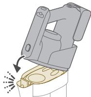
**⚠ Attention : ne replacez pas l'aspirateur à main 3 en 1 sur le bac à poussière avant d'insérer le porte-filtre dans le bac à poussière.**
