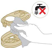
**Achtung:** Reinigen Sie das weiße Material des Filtergehäusedeckels nicht mit einem normalen Staubsauger oder einer Bürste. Reinigen Sie das weiße Material des Filtergehäusedeckels nicht mit Wasser oder Reinigungsmittel. Andernfalls wird das Material beschädigt. Das weiße Material kann über einem Abfalleimer ausgeklopft werden.
