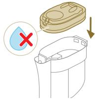
6 Csatlakoztassa újra a 3 az 1-ben kézi egységet a portartályhoz.
