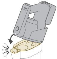
**⚠ Atenție: Nu reatașați aspiratorul de mână 3 în 1 la compartimentul pentru praf fără să introduceți carcasa filtrului în compartimentul pentru praf.**
