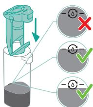
**■** Not: Kirli su seviyesi AUTOCLEAN seviyesinin altındaysa AUTOCLEAN programını başlatmadan önce haznenin boşaltılması gerekmek. Aşağıdaki adımları atlayabilir ve 6. adıma geçebilirsiniz.
