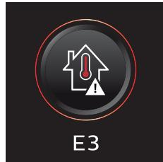
E3  | La temperatura es demasiado alta. | Asegúrate de que la temperatura sea inferior a 35 °C en la habitación donde se usa, almacena o carga el aparato. No expongas el dispositivo a la luz directa del sol ni a altas temperaturas (cerca de estufas calientes, en hornos microondas ni en cocinas de inducción). Las baterías pueden explotar si se sobrecalientan.
