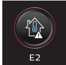
E2   | La temperatura es demasiado baja. | Asegúrate de que la temperatura sea superior a 5 °C en la habitación donde se usa, almacena o carga el aparato.
