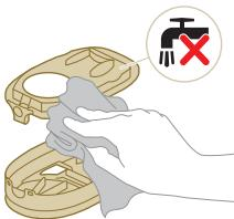
**⚠ Przestroga:** Nie czyścić białego materiału pokrywy obudowy filtru za pomocą zwykłego odkurzacza ani szczotki. Nie czyścić białego materiału pokrywy obudowy filtru przy użyciu wody ani żadnych środków czyszczących. Nieprzestrzeganie tego spowoduje uszkodzenie materiału. **Biały materiał można otrzeć nad koszem.**
