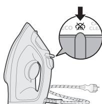
2 مطمئن شوید اتو از برق کنیشیده شده باشد و تنظیم بخار روی حالت بدون بخار (آتو خشک) قرار داشته باشد.
