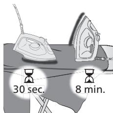
۲ اگر دستگاه برای بیشتر از ۳۰ ثانیه روی کف اتو یا بیشتر از ۸ دقیقه روی پاشنه بدون استفاده بماند، وارد حالت خاموش شدن خودگار می‌شود.
