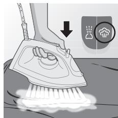
2 دکمه افزایش بخار را فشار داده و رها کنید تا پخار با شدت بیشتری خارج شود و چروک‌های سخت برطرف نشوند.
