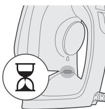
6 وقتی چراغ آمده بودن اتو خاموش شد، کمی صبر کنید و بعد اتوکش را شروع کنید. چراغ آمده بودن اتو در طول اتوکش گاهی روشن می شود.
