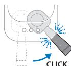
Met de functie voor onmiddellijk starten kan je gemakkelijk je apparaat aanzetten en heerlijke koffie zetten. Er is geen aan/uit-knop. Druk simpelweg op de knop voor de koffie die je wilt zetten. Beweeg de portafilter vervolgens naar rechts om het malen en het koffiezetteren te starten.
