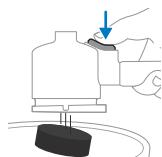
Met deze uitwerpknop kan je eenvoudig het koffiedik na elke koffiebereiding verwijderen. Verwijder het koffiedik door de portafilter ondersteboven te houden en op de uitwerpknop te drukken.
