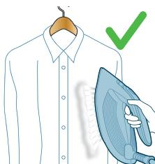
1 Likalnik držite v navpičnem položaju, pritisnite sprožilnik pare in se oblačila rahlo dotaknite z likalno ploščo ter likalnik premikajte navzgor in navzdol.
