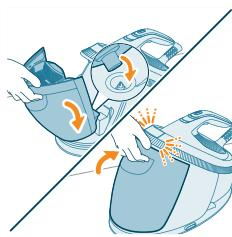
**3** 将水箱放回产品中时，先装入水箱底部。然后推入水箱顶部，直至其锁定到位（可听到“咔哒”声）。
