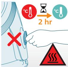
**Varovanie:** Ak chcete spotrebič odvápníť skôr, ako sa spustí pripomienka CALC alebo po žehlení, pred vykonaním postupu Easy DE-CALC skontrolujte, či je spotrebič odpojený od elektrickej siete a nepoužíval sa aspoň 2 hodiny, aby ste predišli riziku popálenia.
