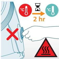
**Попередження:** Щоб видалити накип із пристрою до появі нагадування про видалення накипу під час або після прасування, для запобігання опікам перевірте, чи пристрій від'єднано від електромережі, та дайте йому охолонути протягом щонайменше 2 годин, а потім виконайте процедуру легкого видалення накипу.
