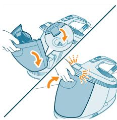
**3** Επανατοποθετήστε το δοχείο νερού στη συσκευή, τοποθετώντας πρώτα το κάτω μέρος στη συσκευή. Στη συνέχεια, πιέστε προς τα μέσα το πάνω μέρος του δοχείου νερού μέχρι να ασφαλίσει στη θέση του ("κλικ").
