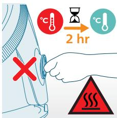
**Aviso:** Se quiser remover as impurezas do aparelho antes que o lembrete da função calc seja ativado ou após usar o ferro, certifique-se de que o aparelho esteja desconectado da tomada e resfriado por pelo menos 2 horas antes de executar o procedimento Easy DE-CALC para evitar o risco de queimaduras.
