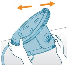
6 Поверните регулятор EASY DE-CALC против часовой стрелки. Потяните за регулятор EASY DE-CALC, чтобы извлечь его.
