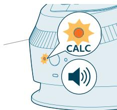
**1** Indikator Easy De-Calc počinje da trepće, a aparat emituje neprekidni zvučni signal.
