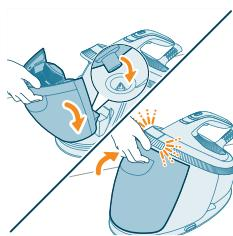
3 Поставете водния резервоар обратно в уреда, като поставите първо долната му част в уреда. След това натиснете горната част на водния резервоар, докато не се захване на мястото си (с щракване).
