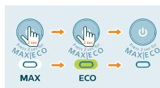
**4** 要停用强力蒸汽模式并回到默认设置，请按住开/关按钮大约 2 秒钟，直到绿色蒸汽设置指示灯亮起。再次按下开/关按钮约 2 秒钟，直至蒸汽设置指示灯熄灭。
