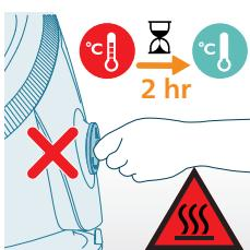
**Waarschuwing:** Als u het apparaat wilt ontkalken voordat u de ontkalkingsherinnering hebt gekregen of na het strijken, zorg er dan voor dat de stekker van het apparaat uit het stopcontact is gehaald en dat het apparaat ten minste 2 uur heeft kunnen afkoelen voordat u de ontkalkingsprocedure uitvoert om risico op brandwonden te voorkomen.
