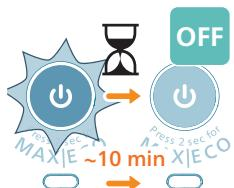
2 Als het apparaat vervolgens nog eens 10 minuten niet wordt gebruikt, wordt het automatisch uitgeschakeld.
