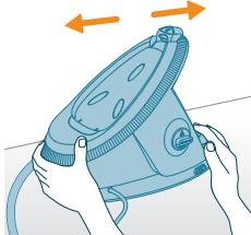
6 EASY DE-CALC düğmesini saat yönünün tersine çevirin. EASY DE-CALC düğmesini çekerek çıkarın.
