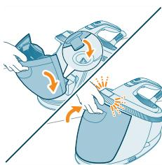
**3** Вратете го резервоарот за вода во апаратот така што прво ќе го вметнете долниот дел. Потоа, туркајте го горниот дел на резервоарот за вода сè додека не легне на место („кликување“).
