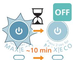
2 Jos laitetta ei käytetä seuraavaan 10 minuuttiin, se sammuu automaattisesti.
