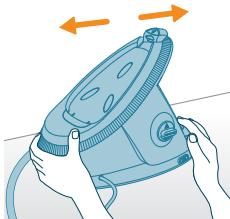
6 Ruotare la manopola EASY DE-CALC in senso antiorario. Estrarre la manopola EASY DE-CALC e rimuoverla.
