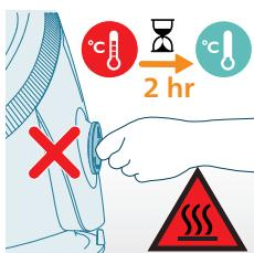
**Varning!** Om du vill avkalka apparaten innan påminnelsen om avkalkning kommer eller efter att du har strukit ska du dra ur kontakten till apparaten och låta apparaten svalna i minst två timmar innan du utför EASY DE-CALC-proceduren för att undvika risk för brännskador.
