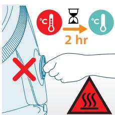
**Varoitus:** Jos haluat suorittaa laitteelle kalkinpoiston ennen kalkinpoiston muistutusta tai silityksen jälkeen, varmista, että laite on irrotettu pistorasiasta ja jäähdytynyt vähintään 2 tuntia ennen Easy DE-CALC -toiminnon suorittamista, jotta vältät mahdolliset palovammat.
