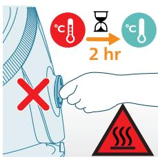
**Cảnh báo:** Nếu bạn muốn tẩy cặn thiết bị trước khi lời nhắc calc bật hoặc sau khi ủi, hãy đảm bảo rằng thiết bị đã được rút phích cắm và để nguội ít nhất 2 giờ trước khi thực hiện quy trình Easy DE-CALC để tránh nguy cơ bị bỏng.
