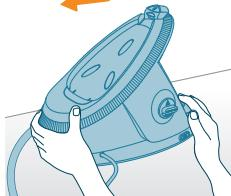
6 转动 EASY DE-CALC 旋钮，逆时针转动该旋钮。拉出 EASY DE-CALC 旋钮以将其拆下。
