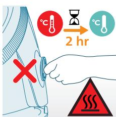
**Opozorilo:** če želite vodni kamen iz aparata odstraniti, preden zasveti indikator za odstranjevanje vodnega kamna ali po likanju, naj bo aparat izključen iz električnega omrežja in pustite ga, da se pred postopkom Easy DE-CALC hladi vsaj 2 uri. Tako se boste izognili tveganju opeklin.
