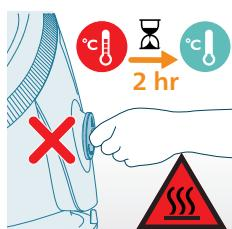
**تحذير:** إذا كنت تريـد إزالة الترسـيبات الكلـسية منـ الجـهاـز قبل ظـهـور تـذـكـيرـ الكلـس أوـ بـعـدـ الـكـيـ تـأـكـدـ مـنـ فـصـلـ الـجـهاـزـ عـنـ الـكـهـرـيـاءـ وـقـرـگـهـ لـيـبـرـدـ لـمـدـدـ سـاعـتـيـنـ عـلـىـ الـأـقـلـ قـبـلـ تـنـفـيـذـ إـجـرـاءـ Easy DE-CALC لـتـجـنبـ خـطـرـ الـاحـتـراـقـ.
