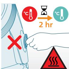
**Advarsel:** Hvis du vil avkalke apparatet før påminnelsen om avkalking vises eller etter stryking, må du kontrollere at apparatet er koblet fra og har vært avkjølt i minst 2 timer før du utfører Easy DE-CALC-prosedyren, slik at du unngår brannskader.
