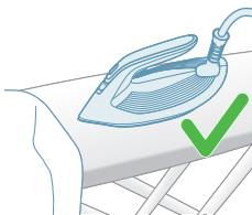
Tijdens het strijken kunt u het strijkijzer op het strijkijzerplateau of horizontaal op de strijkplank plaatsen. Dankzij de OptimalTEMP-technologie beschadigt de zoolplaat niet de strijkplankhoes.
