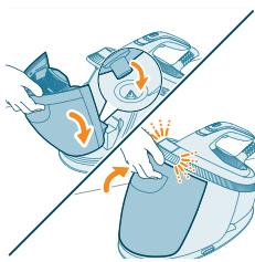
**3** Установите резервуар для воды на место, сначала поместив в прибор его нижнюю часть. Затем задвиньте верхнюю часть резервуара для воды до упора (должен прозвучать щелчок).
