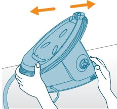
6 Okrenite regulator EASY DE-CALC u smjeru suprotnom od smjera kazaljke na satu. Izvucite regulator EASY DE-CALC kako biste ga odvojili.
