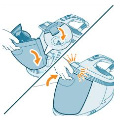
**3** Jihozning pastki qismini qo'yish orqali suv bakini ortga qaytaring. Keyin suv baki joyiga quflangunicha ("tiq" etgunicha) yuqori qismini itaring.
