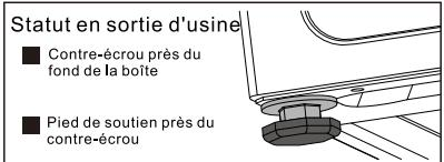
**⚠ Remarque : il se peut que les pieds ne soient pas complètement verrouillés en sortie d'usine, assurez-vous de verrouiller les quatre pieds avant de régler le niveau !**
