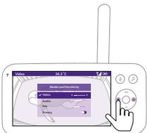
Pour sélectionner différents niveaux de sensibilité en fonction des différents modes, appuyez sur la partie gauche ou droite du bouton de commande.
