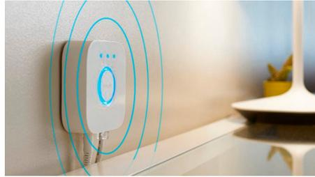
Le pont Hue est un composant essentiel du système d'éclairage personnel intelligent Philips Hue. C'est le cerveau de l'opération, communiquant à la fois avec vos ampoules intelligentes et l'application Hue pour s'assurer que tout fonctionne ensemble. Il permet également des fonctions domotiques intelligentes telles que les routines de programmation et les minuteries.
