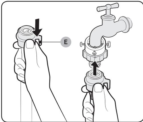
6. Tout en maintenant la **partie (E)** vers le bas, raccordez le tuyau d'arrivée d'eau à l'adaptateur. Puis, relâchez la **partie (E)**. Le tuyau s'adapte dans l'adaptateur en émettant un clic.
