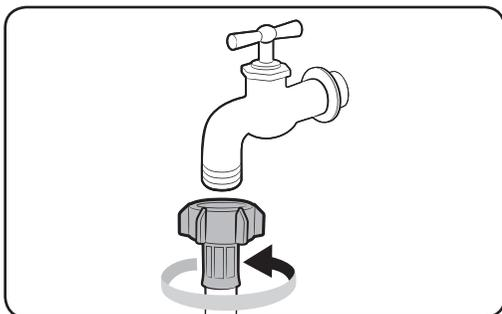
7. Si vous utilisez un robinet d'eau de type à vis, utilisez l'adaptateur de type à vis prévu pour être raccordé au robinet d'eau comme indiqué.
