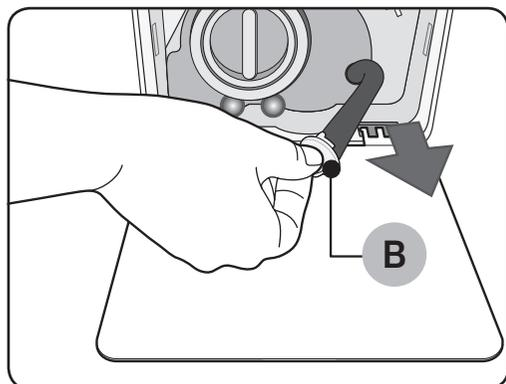
3. Placez un réservoir vide et assez grand autour du couvercle, et étirez le tube de vidange d'urgence autour du couvercle jusqu'au réservoir tout en tenant le **capuchon du tube (B)**.
