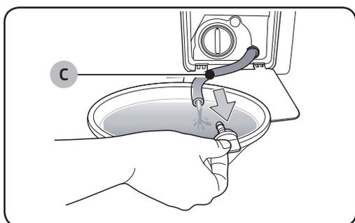
4. Ouvrez le capuchon du tube et laissez l'eau du **Tuyau de Vidange d'urgence (C)** s'écouler dans le réservoir.
