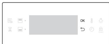
2. Appuyez sur
