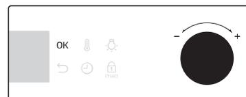
1. Lorsque l'élément Heure clignote, tournez le cadran des valeurs (le cadran côté droit) pour régler l'heure, puis appuyez sur **OK** pour passer sur l'élément Minute.
