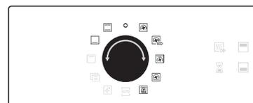
2. Tournez le sélecteur de mode pour sélectionner un mode de cuisson. Vous pouvez sélectionner le mode Gril, Convection, et Chaleur par le haut + Convection sur le compartiment supérieur et le mode Convection, Chaleur par le bas + Convection, et Chaleur par le bas sur le compartiment inférieur.
