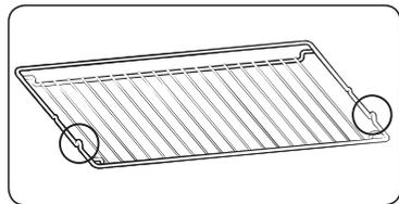
Insérez la grille métallique avec les pièces saillantes (freins sur les deux côtés) vers l'avant de sorte que celle-ci maintienne le support pour les charges importantes.
