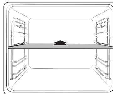
Insérez la plaque séparatrice sur le niveau 3 pour diviser l'enceinte de cuisson en deux compartiments. Le four détecte la plaque séparatrice et active le compartiment supérieur par défaut.
