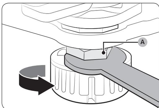
3. Une fois l'opération terminée, serrez l'écrou de blocage (A) en le faisant tourner dans le sens antihoraire.
