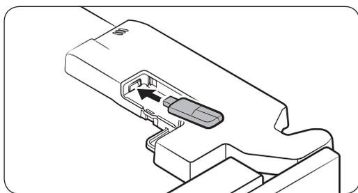
3. Insérez le Smart Home Adapter dans le port d'adaptateur dans le bon sens.
