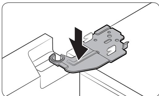
2. Remettez la charnière en position, puis insérez-la dans l'orifice sur la porte.
