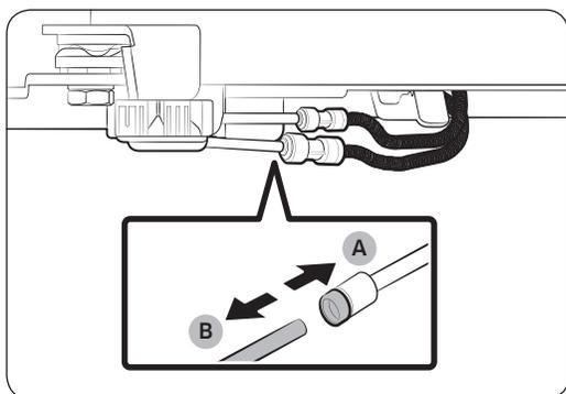
2. Pour débrancher les flexibles, maintenez le coupleur transparent (A) enfoncé et détachez le tuyau d'eau (B).
