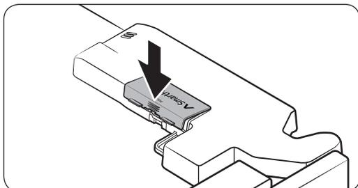
4. Insérez d'abord la partie supérieure du cache de l'adaptateur, puis fermez pour verrouiller, comme indiqué.
