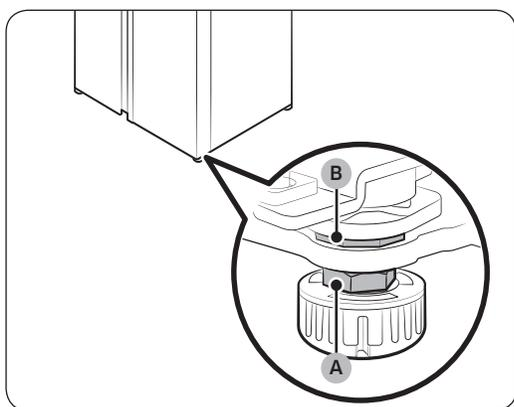
1. Ouvrez la porte pour la régler et repérez les deux écrous (A) et (B) en bas de la façade de la porte.
