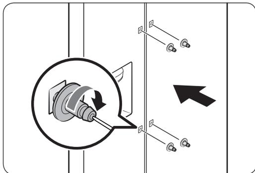
2. Utilisez un tournevis cruciforme pour assembler les pièces de fixation dans les trous, en les serrant dans le sens horaire.
