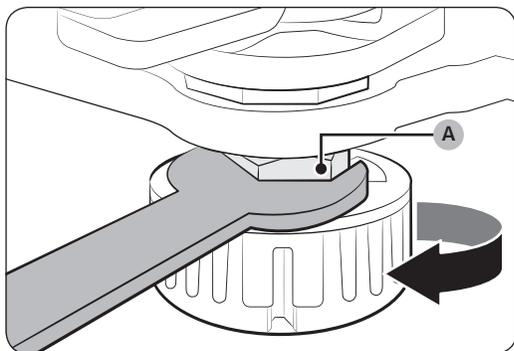
2. À l'aide d'une clé de 19 mm (non fournie), faites tourner l'écrou de blocage (A) dans le sens horaire pour le desserrer. Puis, ouvrez la porte et effectuez les réglages à l'intérieur.
