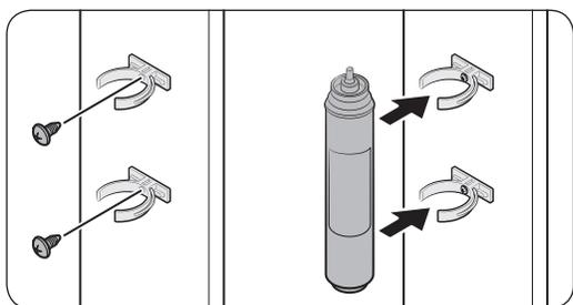
1. Attachez les **clips de sécurité** (x2) sur les positions appropriées, en dessous de l'évier par exemple. Ensuite, fixez fermement les **clips de sécurité** à l'aide de vis.
