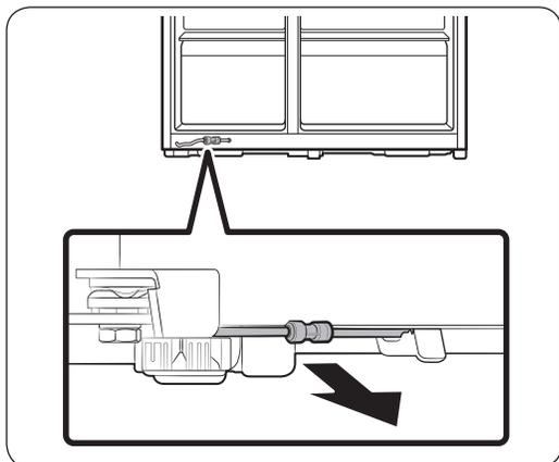
1. En partant de la partie basse à l'arrière du réfrigérateur, faites sortir le tuyau d'eau à l'avant.
