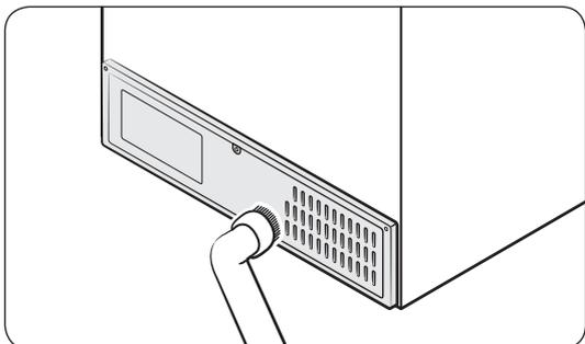
Pour maintenir la propreté des cordons et des pièces exposées du panneau arrière, passez un coup d'aspirateur sur le panneau une ou deux fois par an.
