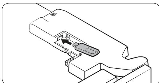
3. Insérez l'adaptateur Smart Home Adapter dans le port de l'adaptateur, dans le bon sens.
