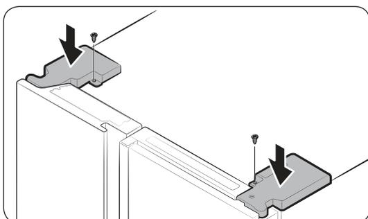
6. Insérez les caches des charnières par l'avant en premier, puis serrez les vis. Utilisez un tournevis cruciforme pour cette opération.
