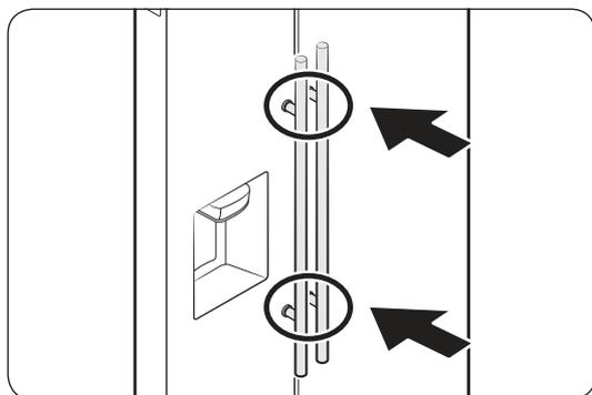
2. Pressez fermement les poignées sur les supports. Vérifiez que les poignées sont fermement fixées en place.
