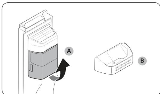
Si vous n'utilisez pas la machine à glaçons et que vous avez besoin de plus de place, retirez le **bac de la machine à glaçons (A)**. Ensuite, insérez le **guide du congélateur (en option) (B)** à la place du bac de la machine à glaçons.
