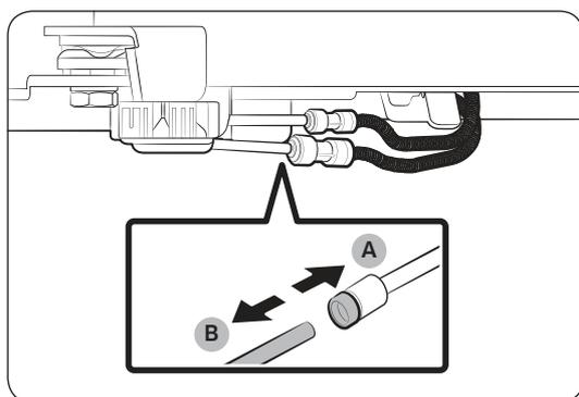
1. En partant de la partie basse à l'arrière du réfrigérateur, faites sortir le tuyau d'eau à l'avant.
