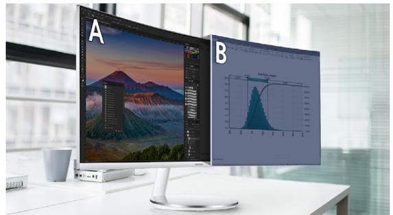
Le mode Picture-by-Picture (PbP) vous permet d'afficher deux sources différentes à l'écran à leur résolution native. Et pour un multitâche optimal, le mode PIP (Picture-in-Picture), vous permettra de redimensionner la seconde source jusqu'à 25% de l'écran et la positionner n'importe où.
