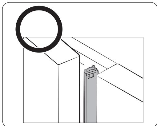
Lorsque la poutre mobile au milieu est en tel statut, la porte peut être fermée normalement.
