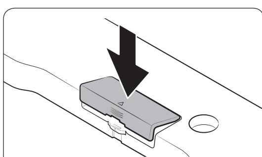
4. Insérez la partie supérieure du couvercle du Dongle d'abord, puis le verrouillez comme indiqué dans la figure.
