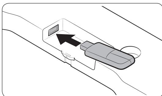
3. Insérez le Dongle Domestique Intelligent dans le port de dongle au sens correct.
