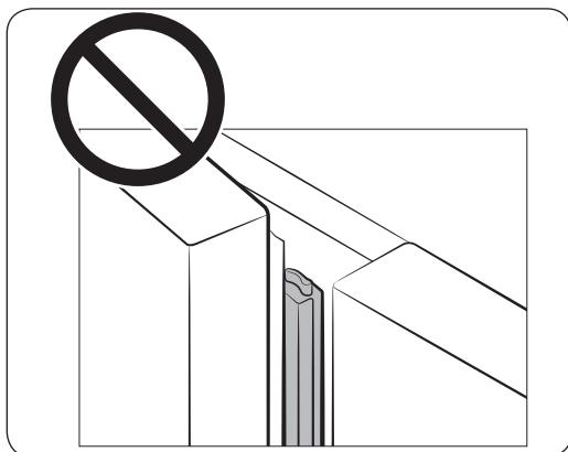
Lorsque la poutre mobile au milieu est en tel statut, la porte ne peut pas être fermée normalement.
