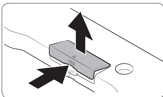
1. Appuyez au-dessus pour déverrouiller la zone de flèche du couvercle du dongle.
