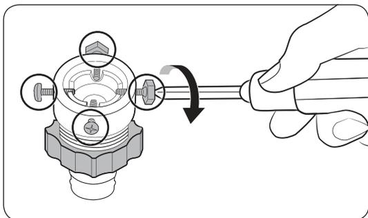
Raccordez le tuyau d'eau au robinet.
