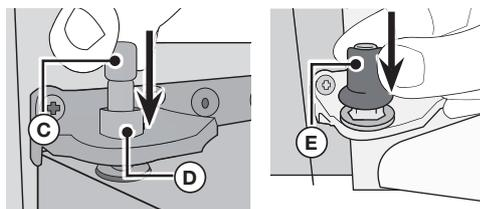
3. Lorsque la porte est ouverte, assemblez les connecteurs situés au bas de la porte.
