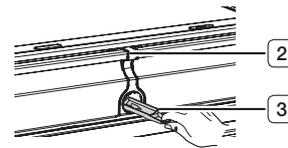
3. Insérez le filtre neuf dans le logement ( 4 ).
