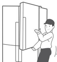
2. Faites glisser la charnière du réfrigérateur (A) dans la rainure de fixation puis appuyez dessus afin de l'aligner avec l'orifice dans la porte.
