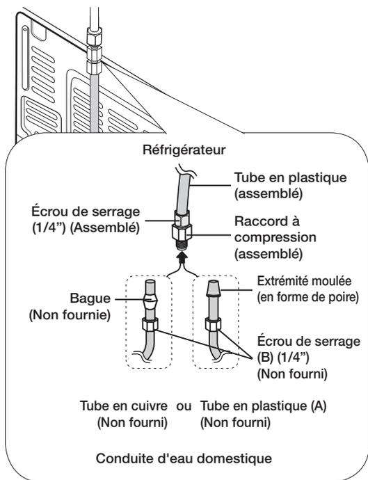
1. Reliez la conduite d'eau domestique au raccord à compression assemblé.
