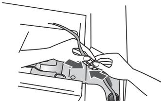
5. Connectez le tuyau d'eau (C). Branchez les deux connecteurs situés sur la porte gauche et le connecteur (E) situé sur la porte droite.
