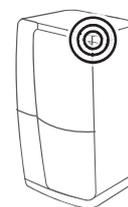
1. Les portes étant fermées, retirez les 3 vis fixant le cache supérieur à l'aide d'un tournevis cruciforme, puis soulevez-le avec les câbles connectés.
