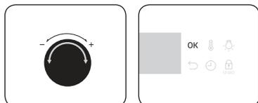
3. Tournez le cadran de valeur pour sélectionner valeur pour sélectionner **Nettoyage par pyrolyse (C 2)**, puis appuyez sur **OK**.
