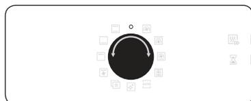
Lorsque la cuisson est en cours, tournez le sélecteur de mode sur « 0 ». Le four s'éteint après quelques secondes. Ceci est dû au fait que, pour éviter d'accepter des commandes incorrectes de la part des utilisateurs, le four attend quelques secondes afin qu'ils puissent corriger leur sélection.
