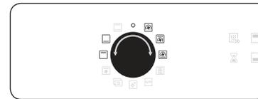
2. Tournez le sélecteur de mode pour sélectionner le mode de cuisson. Vous pouvez sélectionner le mode Gril, Convection, et Chaleur par le haut + Convection sur le compartiment supérieur et le mode Convection, Chaleur par le bas + Convection, et Chaleur par le bas sur le compartiment inférieur.
