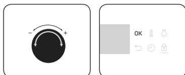
4. Tournez le cadran de valeur pour sélectionner une durée de nettoyage à partir de 3 niveaux : 1 h 50 min, 2 h 10 min et 2 h 30 min.
