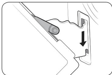
3. Après nettoyage, répétez les étapes 1 et 2 dans l'ordre inverse pour refixer la porte. La fixation de la charnière doit être fermée de chaque côté.
