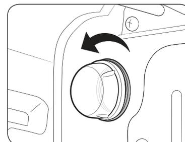
1. Retirez le cache en verre en le tournant dans le sens inverse des aiguilles d'une montre.
