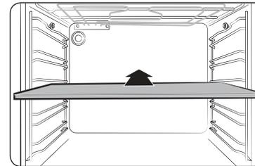
1. Insérez la plaque séparatrice sur le niveau 3 pour diviser l'enceinte de cuisson en deux compartiments.
