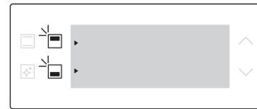
2. Appuyez sur **☐** pour sélectionner la zone supérieure, ou appuyez sur **☐** pour sélectionner la zone inférieure. Le voyant **▶** apparaît à côté de la zone sélectionnée.
