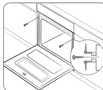
Placez le four dans le meuble et fixez-le fermement des deux côtés en utilisant 2 vis.
