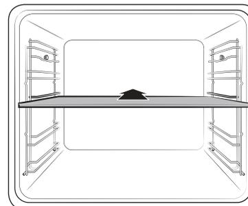
Insérez la plaque séparatrice sur le niveau 3 pour diviser l'enceinte de cuisson en deux zones. Le four détecte la plaque séparatrice et active la zone supérieure par défaut.
