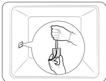
1. Maintenez l'extrémité inférieure de la protection de l'éclairage latéral du four d'une main, et utilisez un outil fin et plat tel qu'un couteau de table pour retirer la protection comme indiqué.
