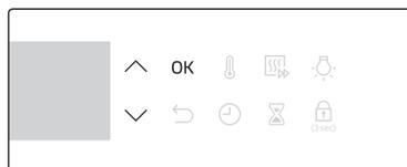
3. Sélectionnez un temps de nettoyage parmi les 3 niveaux proposés : 1 h 50 min, 2 h 10 min et 2 h 30 min.
