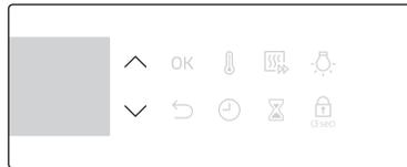
2. Utilisez les boutons  $\wedge$  /  $\vee$  pour régler la température.
