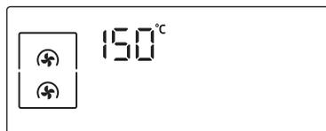
Le four démarre le préchauffage jusqu'à avoir atteint la température cible. Lorsque le préchauffage est terminé, le voyant disparaît en émettant un signal sonore. Le préchauffage est recommandé pour tous les modes de cuisson sauf indication contraire dans le guide de cuisson.
