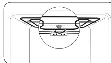
3. Une fois cela fait, réinstallez l'élément chauffant du gril et tournez l'écrou circulaire dans le sens horaire.
