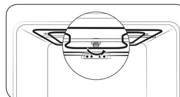
1. Déposez l'élément chauffant du gril. Pour ce faire, tournez l'écrou circulaire dans le sens anti-horaire tout en tenant l'élément chauffant du gril en place. L'élément chauffant du gril n'est pas une pièce amovible. Ne tirez pas sur l'élément chauffant du gril pour le retirer.
