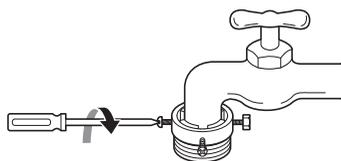
4 Pousser le tuyau d'entrée ③ vers le haut de sorte que le joint en caoutchouc du tuyau soit bien en contact avec le robinet, puis serrer le tuyau en le vissant vers la droite.
