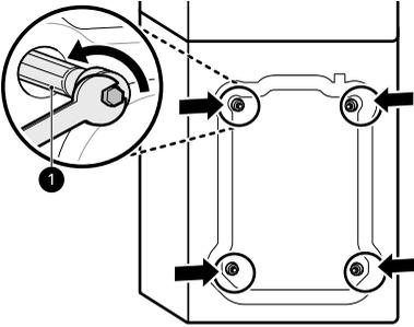
**2** Retirer les boulons en les agitant légèrement en les tirant.
