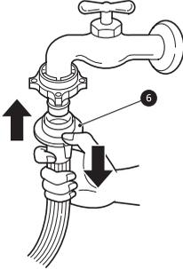
l'alimentation en eau. Au cas où le robinet est carré ou trop grand, retirer la plaque de guidage avant d'insérer le robinet dans l'adaptateur.
