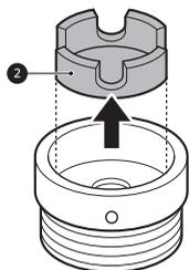
3 Pousser l'adaptateur dans l'extrémité du robinet afin que le joint en caoutchouc forme un raccord étanche. Serrer les 4 vis de fixation.
