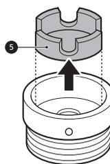
3 Pousser l'adaptateur dans l'extrémité du robinet afin que le joint en caoutchouc forme un raccord étanche. Serrer les 4 vis de fixation et la plaque de la bague d'adaptation.
