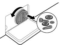
Après avoir nettoyé le filtre de la pompe de vidange, réinsérer soigneusement le filtre et revisser le bouchon de vidange dans le sens des aiguilles d'une montre afin d'éviter des dommages au filetage et des fuites. Réinsérer le bouchon dans le tuyau de vidange et placer
