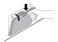
3 Retirer d'abord le bouchon de vidange du tube de vidange, puis vider l'eau.
