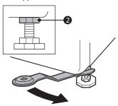
Vérifiez que tous les écrous de blocage situés au bas de l'appareil sont correctement fixés.
