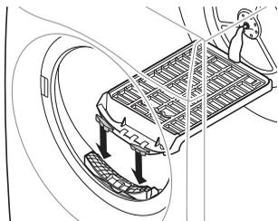
4 Placez les articles mouillés sur le support. Laissez de l'espace autour des articles pour que l'air circule.
