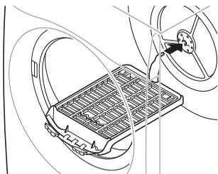
3 Placez le support de séchage sur la structure au-dessus du filtre à peluches et appuyez dessus pour terminer l'assemblage.
