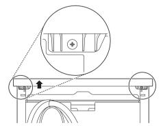
Tirez le couvercle supérieur vers l'arrière après avoir retiré les deux vis, puis soulevez-le pour le retirer. 3 Enlevez les broches de positionnement sur la partie supérieure à l'aide d'un tournevis Phillips.
