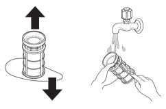
4 Pour remonter les filtres assemblés, positionnez le bras gicleur inférieur de sorte que le grand V soit orienté vers l'avant. Remontez les filtres dans le porte-filtre et fixez-les en tournant le filtre interne dans le sens des aiguilles d'une montre jusqu'à ce qu'il se verrouille en place.
