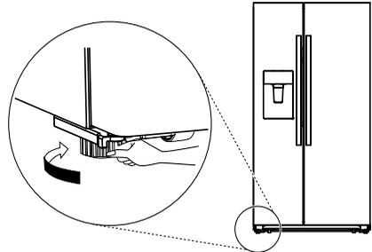
Pour permettre aux portes de se refermer automatiquement, inclinez la partie supérieure vers l'arrière d'environ 15 mm ou 0,5° en tournant les pieds réglables.
