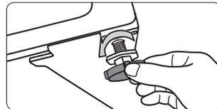
4. Une fois votre lave-linge stabilisé, serrez les écrous de serrage à l'aide de la clé.
