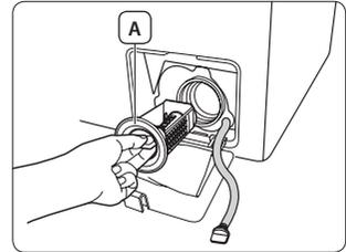
4. Retirez toute impureté et autre corps étranger pris dans le filtre et nettoyez ce dernier. Assurez-vous que l'hélice de la pompe de vidange située derrière le filtre n'est pas bloquée.
