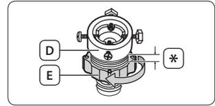
4. Raccordez l'adaptateur au robinet en serrant fermement toutes les vis et en levant l'adaptateur vers le haut. Puis serrez l'adaptateur en tournant la **partie (E)** en suivant la flèche.
